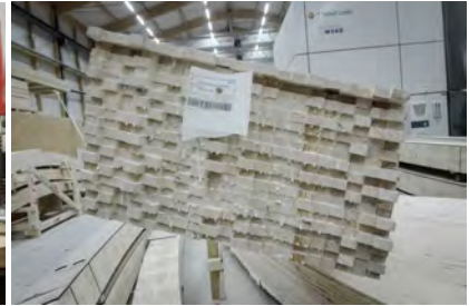
(d) A free-form glulam blank at Blumer Lehmann AG .
